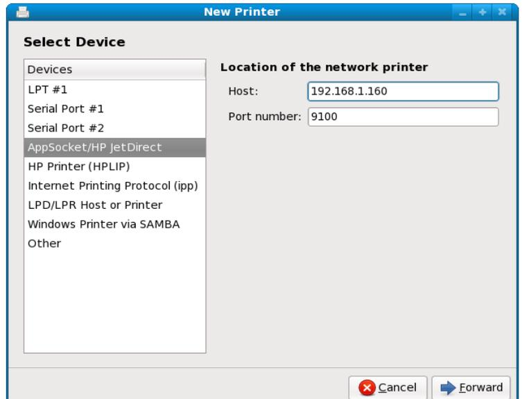
Fig. 13. Specify the Port Parameters
